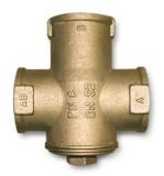
Válvula de 3 vías termostáticas que mantiene la temperatura de la caldera por encima de 55 °C para evitar condensaciones. \*Dispone de balancín que autorregula las pérdidas de carga en las tomas de entrada.
